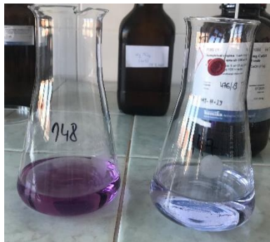
Slika 7. Određivanje ukupne tvrdoće vode (Izvor: autor)
