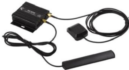
Slika 6 GPS lokator za vozila
