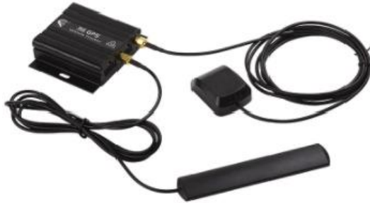
Slika 6 GPS lokator za vozila
