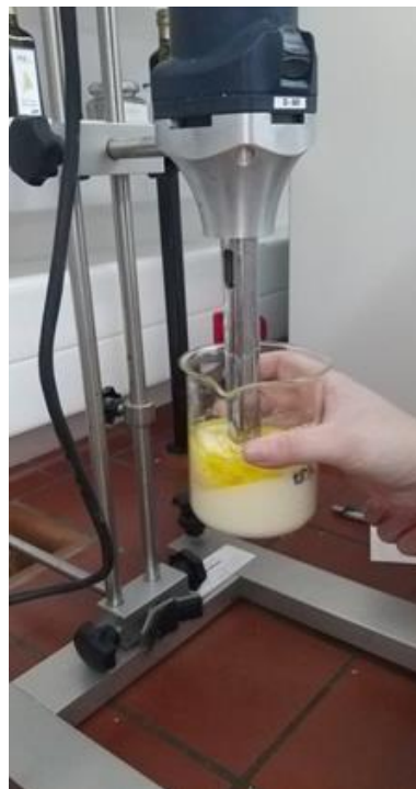
Slika 4. Proizvodnja majoneze pomoću homogenizatora (Izvor: autor)
