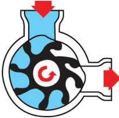
Slika 24. Princip rada impelerske crpke (izvor:www.eriks.co.uk)
