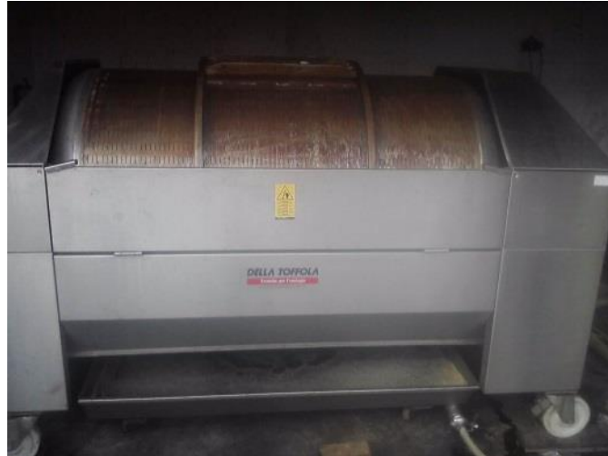
Slika 19. Pneumatski tijesak - otvoreni tip (vlastiti izvor)
