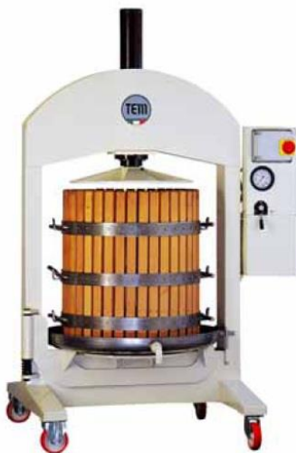
Slika 18. Vertikalni hidraulični tijesak (izvor: www.renaioli.net )
