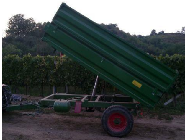
Slika 4. Hidraulički sustav za dizanje (vlastiti izvor)
