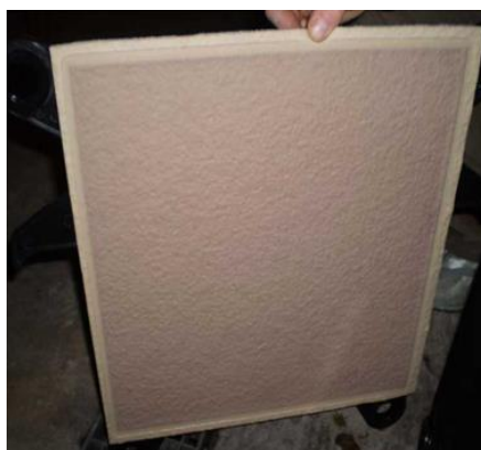
Slika 33. Filter ploča nakon filtracije (vlastiti izvor)
