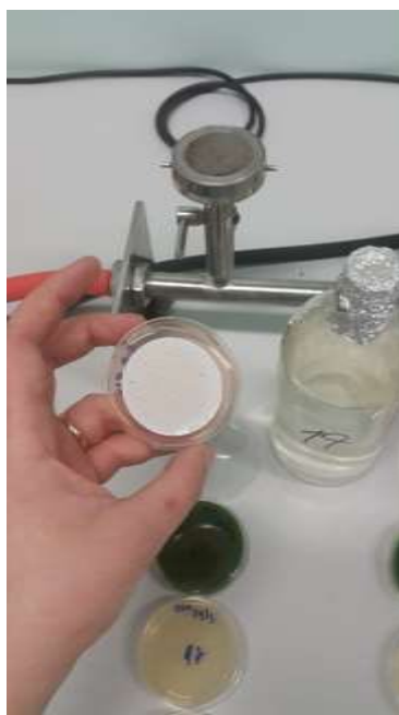
Slika 7. Nacjepljivanje membranskog filtera na petrijevu zdjelicu (Izvor: autor)
