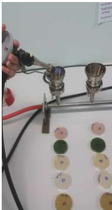
Slika 5. Spaljivanje alkohola (Izvor: autor)
