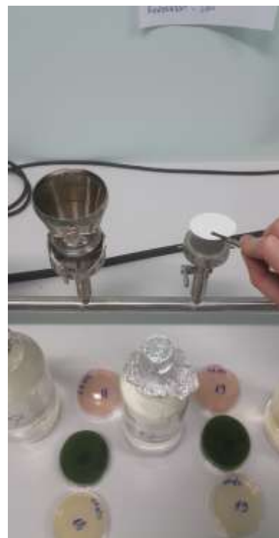
Slika 6. Postavljanje sterilnog membranskog filtera (Izvor: autor)
