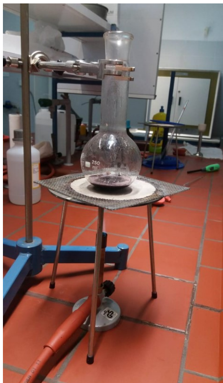
Slika 5. Kuhanje uzorka s HCl (Izvor: autor)
