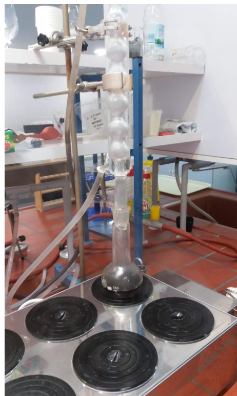
Slika 6. Kuhanje uzorka na vodenoj kupelji (Izvor: autor)
