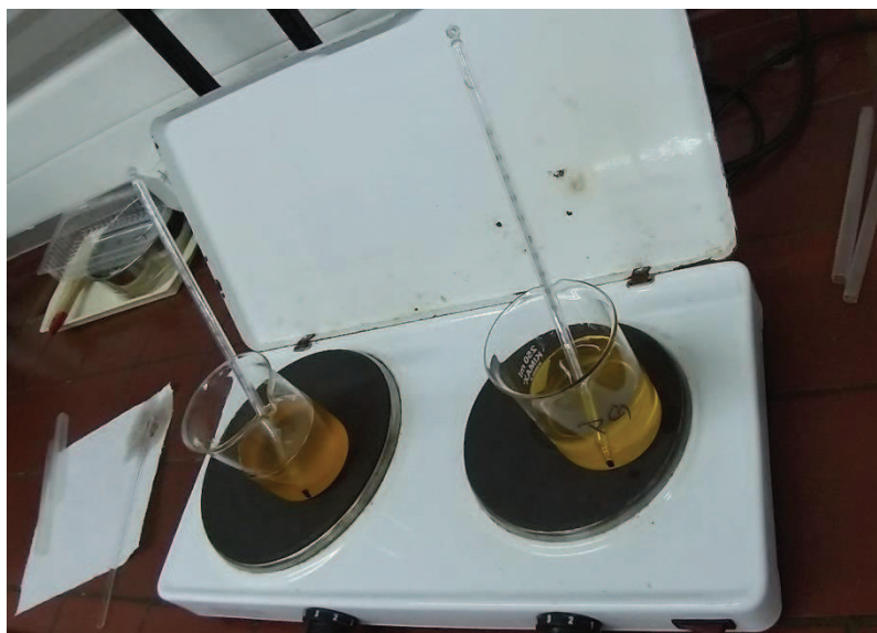
Slika 11. Zagrijavanje ulja uz dodatak antioksidansa, (Izvor: Autor)
