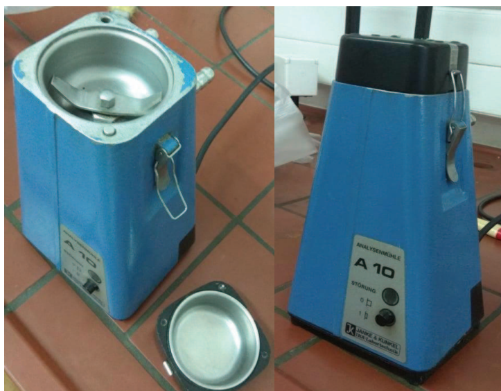
Slika 3. Laboratorijski uređaj za mljevenje (izvor: autor)
