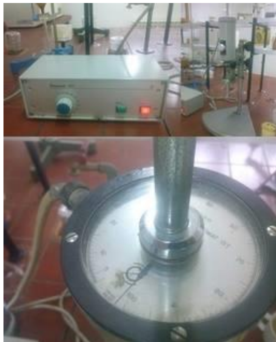
Slika 6 Viskozimetar Rheomat 15T (Izvor: autor)
