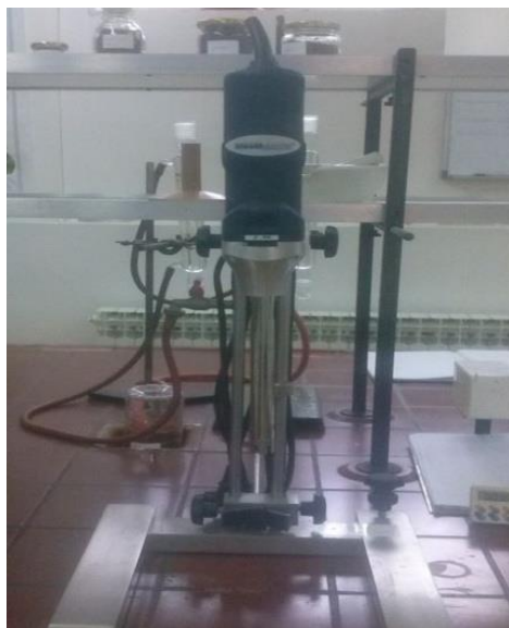
Slika 5 Homogenizator sustav tip rotor/stator (Izvor: autor)
