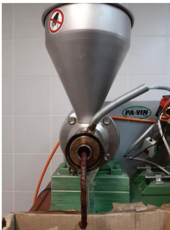
Slika 19. Izlazak pogače iz preše (Vlastiti izvor)
