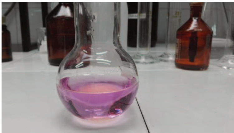
Slika 1. Određivanje SMK titracijom NaOH (Izvor: autor)
