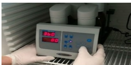
Slika 9. Respirometrijski elektronički uređaj " OxiTop " (Izvor: autor)
