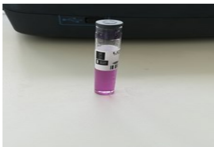
Slika 15. Kiveta sa uzorkom sirove vode i sadržajem željeza (Izvor: autor)
