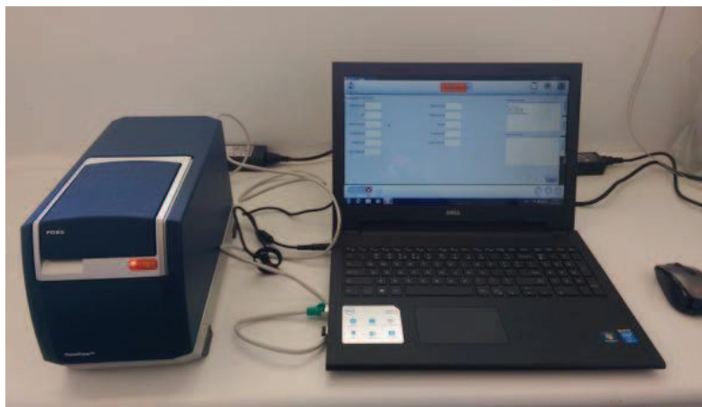
Slika 6. OenoFoss analizator (Izvor: autor)
