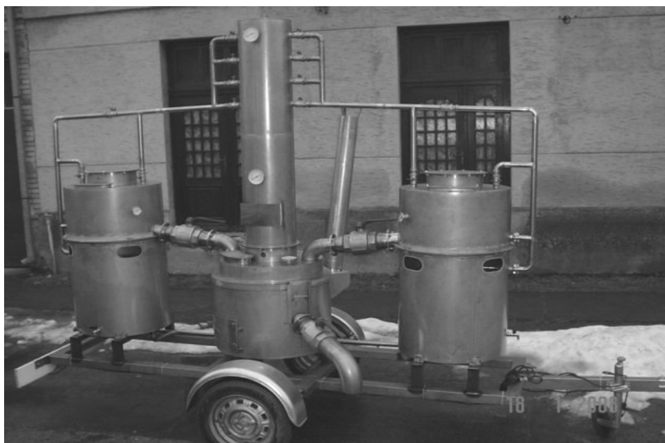
Slika 2.: Mobilno postrojenje za proizvodnju bioetanola „Jakobović“
