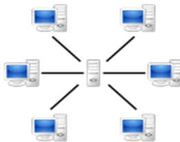
Slika 38. Klasična C/S arhitektura
