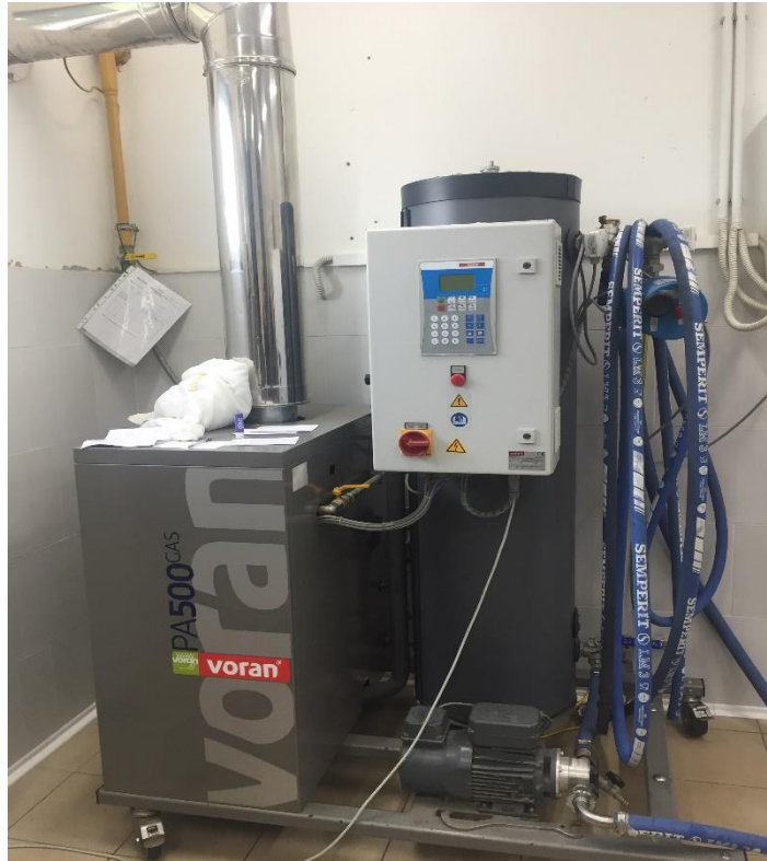
Slika 12. Uređaj za pasterizaciju (Izvor: Autor)
