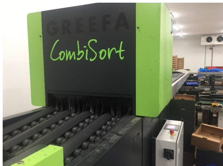
Slika 4. Dio uređaja za sortiranje zadužen za pranje (Izvor: Autor)
