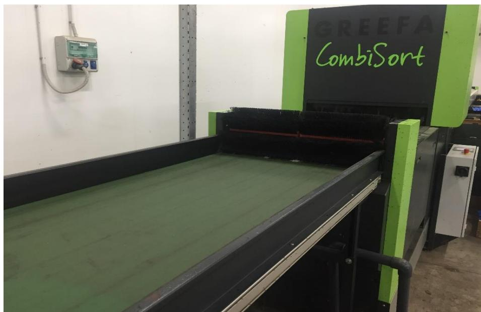
Slika 6. Nastavak uređaja za sortiranje koji vodi do stolova za klasiranje (Izvor: Autor)
