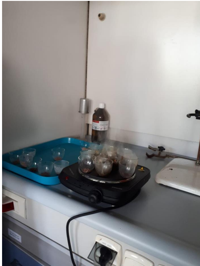
Slika 4. Predspaljivanje na električnoj grijaćoj ploči
